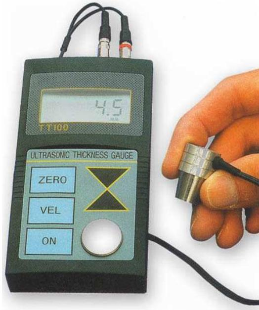
El **TT100** es un medidor de espesores ultrasónico de pared controlado por un microprocesador, específicamente diseñado para medir el espesor de materiales metálicos y no metálicos tales como Acero, Aluminio, Plásticos, Cerámicos y otros materiales buenos conductores del ultrasonido, que además tengan sus superficies superior e inferior paralelas.
