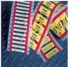
Las marcas termocontraíbles ShrinkMark permiten identificar y codificar sobre todo tipo de cables de control y fuerza. Al termocontraerse, los mangos ShrinkMark se fijan fuertemente sobre la aislación y la tinta de impresión queda capturada en el material asegurando una marca durable y permanente.
