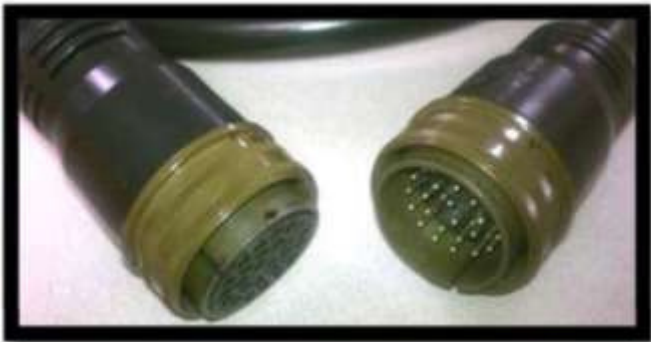
Figura 7. Cable con anillo de acoplamiento de aluminio.
