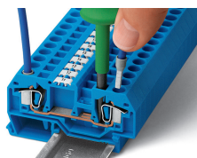
Conexión CAGE CLAMP® (CLEMA CEPO) Inserción de un conductor. Con conductores con puntera, es necesario utilizar una borna cuyo tamaño sea superior a la sección nominal del conductor.
