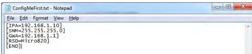
Figura 58 - Ejemplo de configuración de restauración del proyecto
