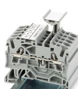
Portaetiquetas de grupos TOPJOB® S 2009-193 (equipado con una tira de marcadores) para todas las bornas TOPJOB® S de las series 2001 a 2016 ¡No utilizar en una placa final!
